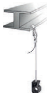
Tubo suspendido por cable
