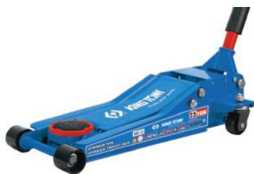
KT9TY133A-25A-B MACACO DE RODAS BAIXO PERFIL Capacidade 2.5 Ton. Alt. mín 85 mm. Alt. máx. 375 mm. 14 kg.
