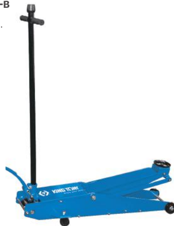
KT9TY342-02A-B / KT9TY342-06A-B CAVALETE CREMALHEIRA 2 unidades. Capacidade 2 / 6 Ton. Alt. mín 278/395 mm. Alt. máx. 423/613 mm. 5.3/13.7 kg.
