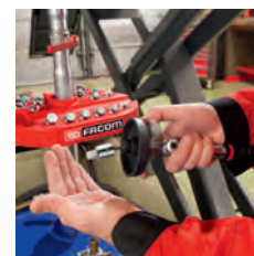
4 Escoar do óleo da aparador directamente no recuperador de óleo.
