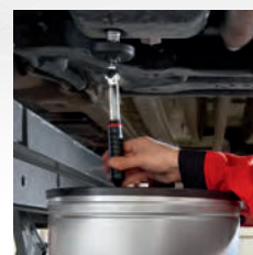
2 No final do desaperto do bujão em posição vertical, as gotas de óleo são aparadas pela aparador de protecção.
